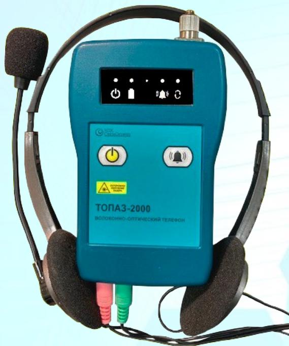
Оптические телефоны **ТОПАЗ-2000** предназначены для организации дуплексной технологической связи по одному одномодовому волокну при монтаже и обслуживании ВОЛС.
