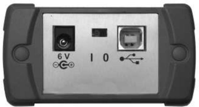
Рис.2.2. Расположение коннектора USB типа B в приборах серии «Тораз-7000-AR»
