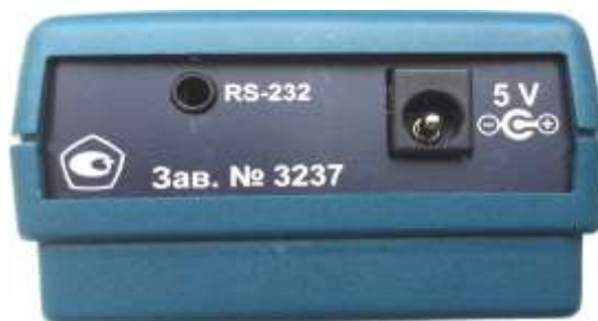
Рис. 2.1. Расположение коннектора «RS-232» в приборах серии «Тораз-7000»
