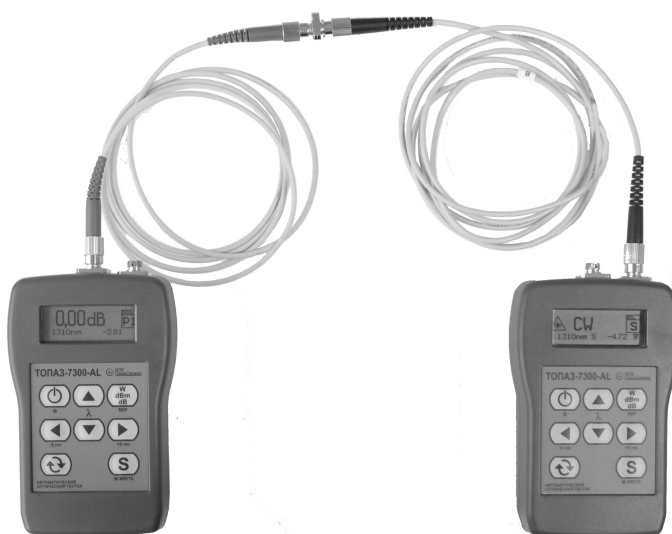
Рис.4. Измерение опорного уровня
