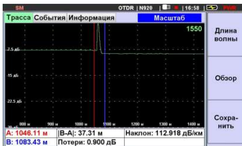
Рис. 5.27. Оценка затухания на коннекторе с помощью двух курсоров
