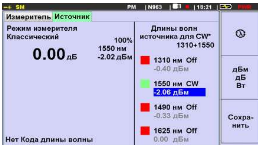
Рис.6.4. Установка эталонного уровня измерителя мощности
