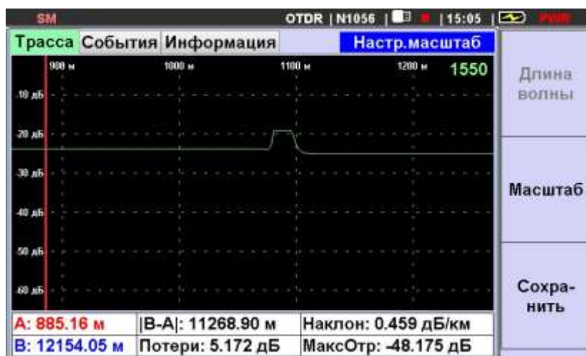
Рис. 5.23. Настройка масштаба отображения рефлектограммы. Увеличение изображения.
