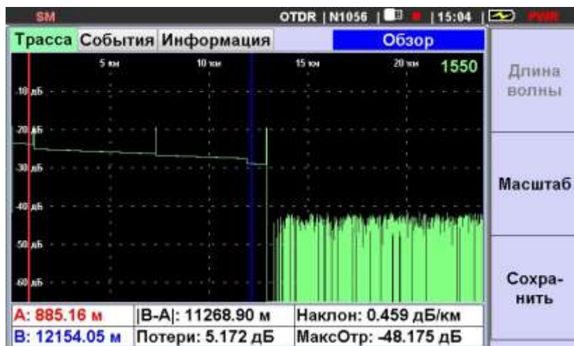
Рис. 5.21. Настройка масштаба отображения рефлектограммы. Установка курсора.
