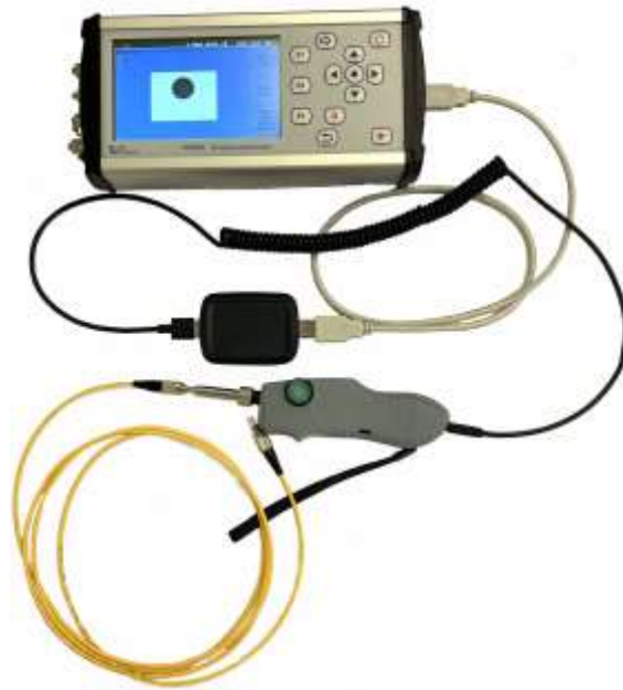
Рис.7.2. Подключение Волоконного микроскопа к рефлектометру серии «Топаз-9400»
