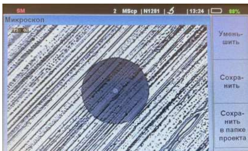
Рис. 7.6. Изображение поверхности тестируемого коннектора после нажатия «F1»
