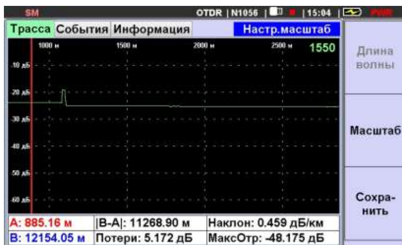
Рис. 5.22. Настройка масштаба отображения рефлектограммы. Переход в настройку.
