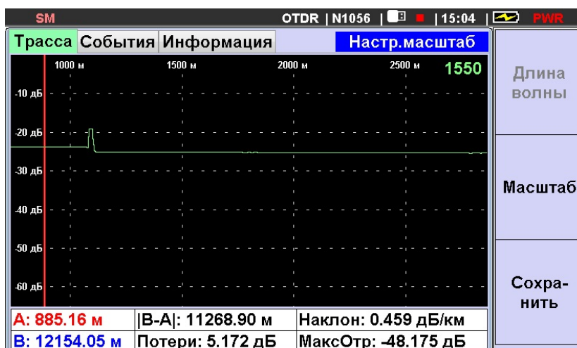
Рис. 5.21. Настройка масштаба отображения рефлектограммы. Переход в настройку.
