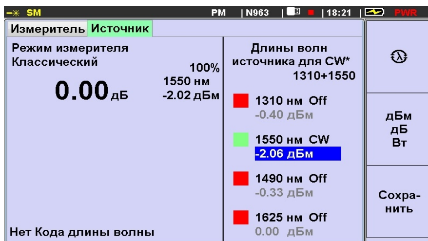
Рис.6.4. Установка эталонного уровня измерителя мощности
